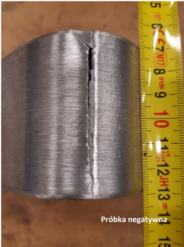
Rysunek 49 - Obrazy akceptowalnego wyniku (brak niedoskonałości po teście, patrz górny obraz) i nieakceptowalnego wyniku (nieudana próbka: dolny obraz) zgodnie z ISO 15614-1.
